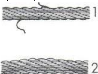
Рис.5 Проверка троса: (1)– использовать трос запрещено; (2) – трос готов к использованию.
