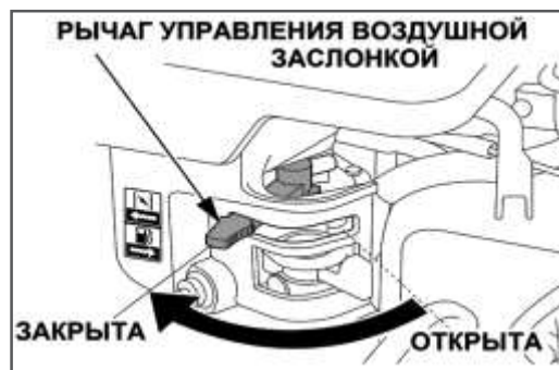
Рис.10 - Воздушная заслонка закрыта
