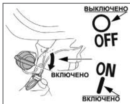
Рис. 12 - Выключатель зажигания в положении «Включено»
