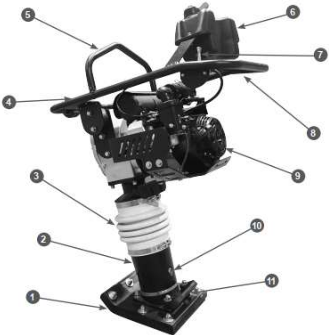
Рис.1 - Основные узлы и органы управления (вид спереди)
