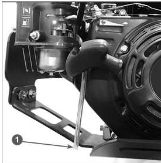
Рис.13 - Дренажная трубка карбюратора 1. Трубка дренажная
